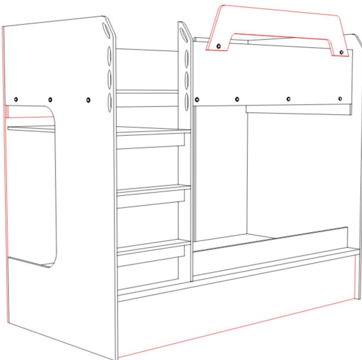
۱- پیچ های الیت روی وادارها و کلگی ها بسته شود
